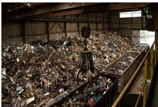
Angelieferter unsortierter Stahlschrott
