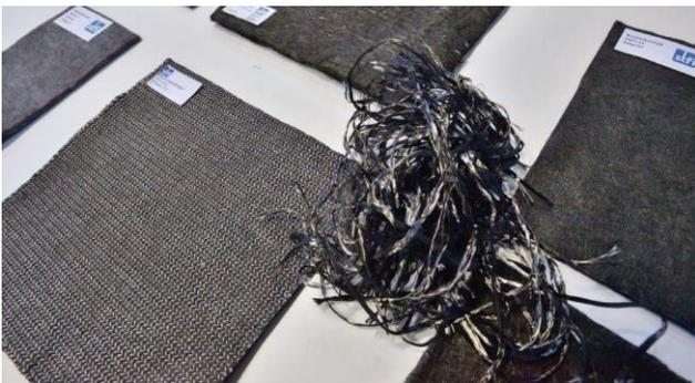
Fasern aus dem Recyclingprozess und Beispielmaterialien aus solchen Fasern.
